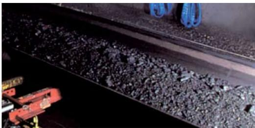
**RESISTENTES A LA TEMPERATURA:** Bandas aptas para resistir el transporte de materiales con temperaturas elevadas y constantes, en el caso de materiales aterronados hasta 180°C, en materiales molidos o a granel 120°C, tales como arena de fundición, cerámicas, escorias, asfalto, etc.
