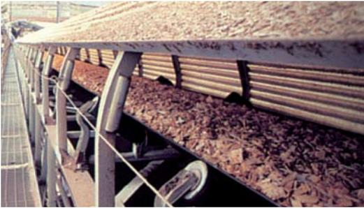
**RESISTENTES A LA ABRASIÓN:** Bandas aptas para el transporte de material abrasivo en general, bajo cualquier condición de servicio, tales como arcilla, cal, canto rodado, tierra, chip de madera, etc.
